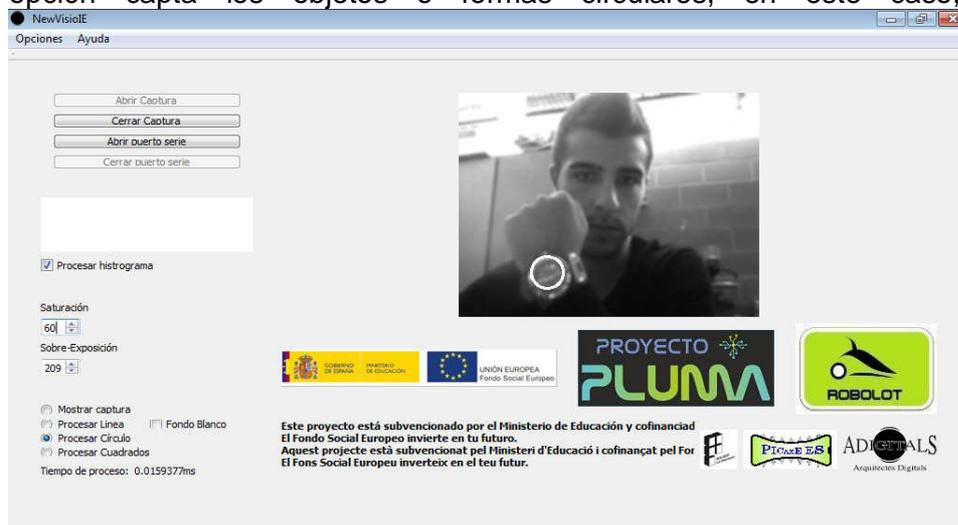
El programa muestra en pantalla los objetos circulares detectados. Durante el funcionamiento, se envía por el puerto serie un valor u otro en función de su ubicación (derecha, centro, izquierda, no detectado) .
