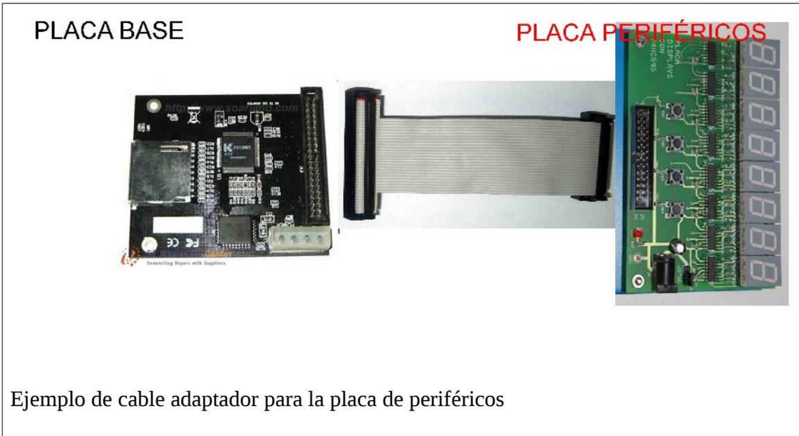
Ejemplo de cable adaptador para la placa de periféricos
