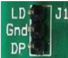
Es un conector macho de tres pines que permite seleccionar como salida del puerto B el display de siete segmentos o los ocho leds rojos de la placa. No se recomienda activar a la vez las dos salidas por el excesivo consumo que supone para el pic.
