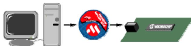
FIGURA 5.- CONEXIÓN DEL ICD A LA PLACA DE DESARROLLO
